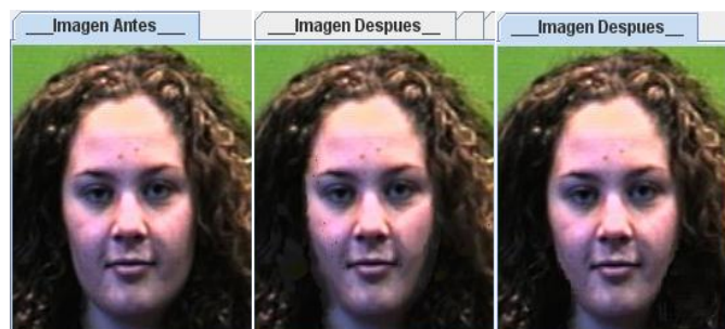
Figura 21: Simulación de Reducción de Papada - Imagen Original, Resultado con Transformación a Coordenadas Polares, Resultado mediante Superficies Producto Tensorial de Bezier
