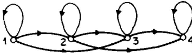
Figura 4.16: HMM izquierda-derecha o modelos Bakis.
