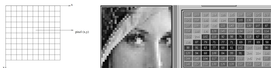
Figura 1: Representação de uma imagem monocromática digital (à esquerda). Ponto indicado sobre o olho de uma imagem da Lenna (centro). Matriz de pixels em uma região de interesse de 10 x 10 pixels em torno do ponto indicado (à direita).
